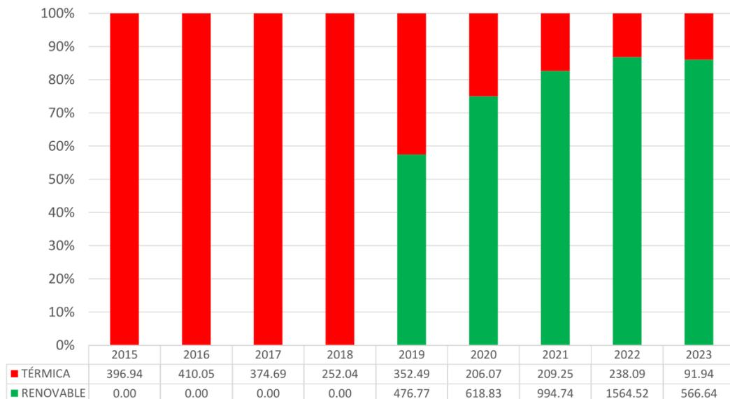
Figura 50 - Porcentajes de componente térmica (rojo) y renovable (verde) en la inyección de energía al SADI entre 2015 y 2022 para Santa Cruz, fuente [IESC-SPEME,2023]
