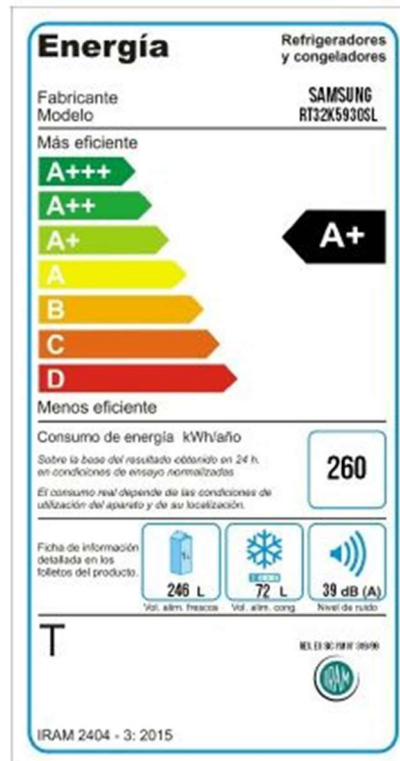
Figura 94 etiquetado reciente de equipos según nueva normativa IRAM (IRAM 2023)
