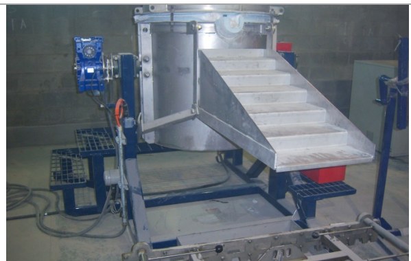
Foto 4.6-11. Horno a utilizar en la fundición para obtener el lingote de metal doré.
