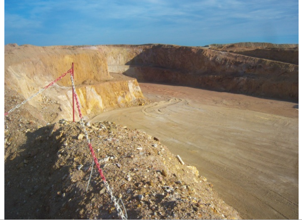
Foto 4.5-2. Vista de los primeros bancos de explotación.
