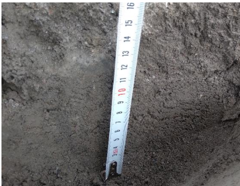
Fotografía 21. Perfil Limo arcilloso compacto Ensayo 1.
