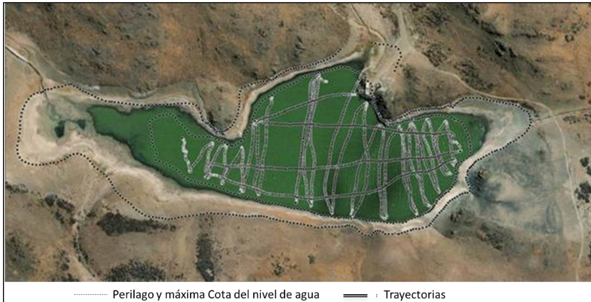
Figura 6.12. Relevamiento topobatimétrico reservorio LG4.
