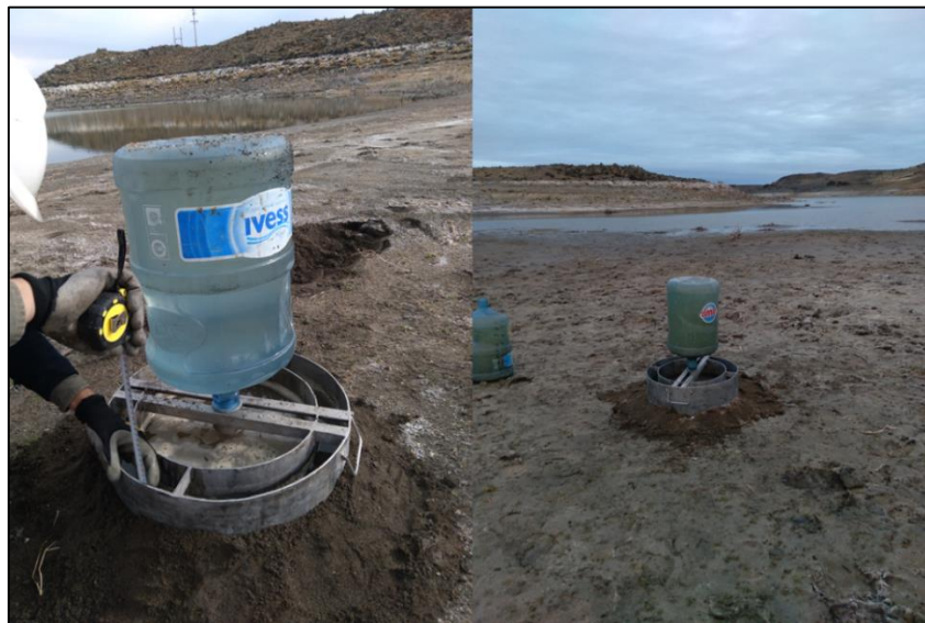
Figura 6.16 Ensayos de infiltración. Izquierda ensayo 3, derecha ensayo 4.
