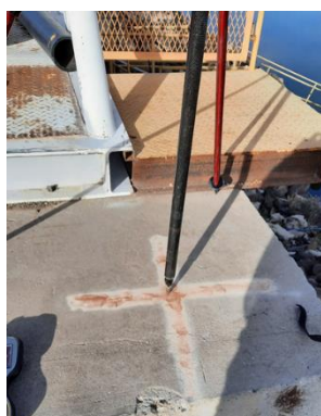
Fotografía 27. Punto Control Topografico LG4.
