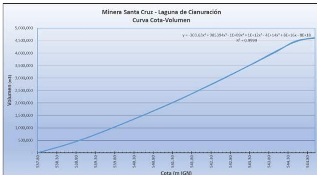
Figura 9.14 Curva y correlación de datos cota volumen dique de cianuración.
