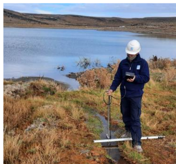
Fotografía 32 Aforo Entrada a LG4 de efluente Tehuelche.
