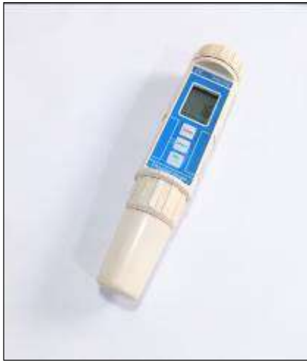
Figura 82. Equipos utilizados (conductímetro y oxímetro) para la medición de conductividad y oxígeno disuelto.
