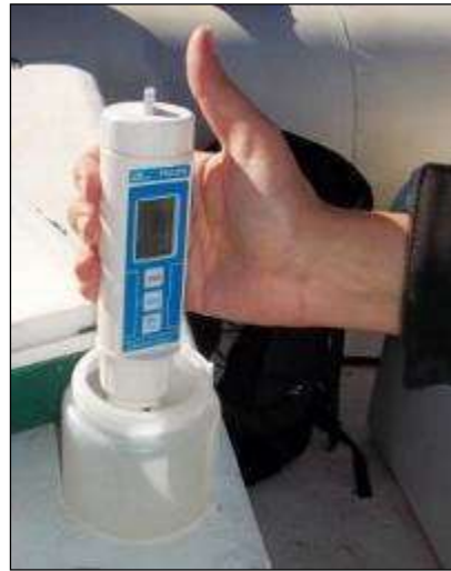
Figura 82. Equipos utilizados (conductímetro y oxímetro) para la medición de conductividad y oxígeno disuelto.
