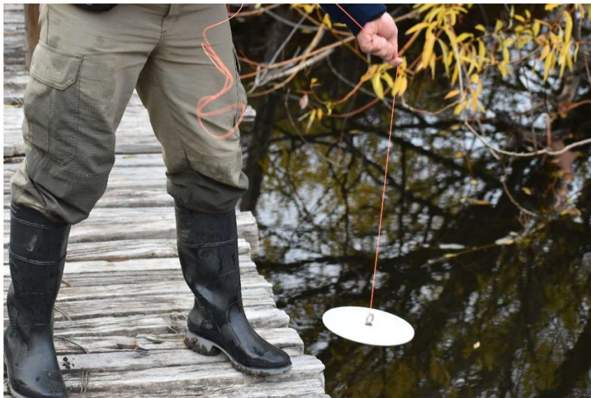
Figura 84: Medición de transparencia con disco de Secchi en el punto 2, Río Pinturas.
