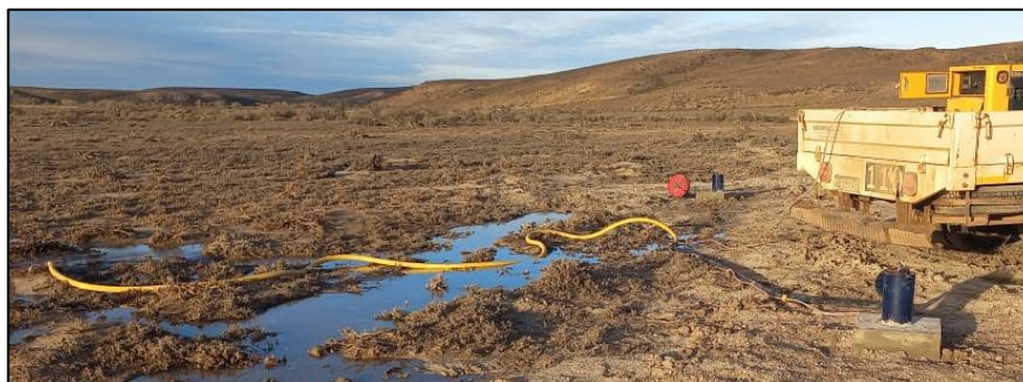
Fotografía 5.1. Bombeo de agua para extracción de muestra de agua subterránea en Naty.
