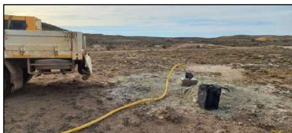
Fotografía 5.7. Desarrollo de pozo previo a toma de muestras.
