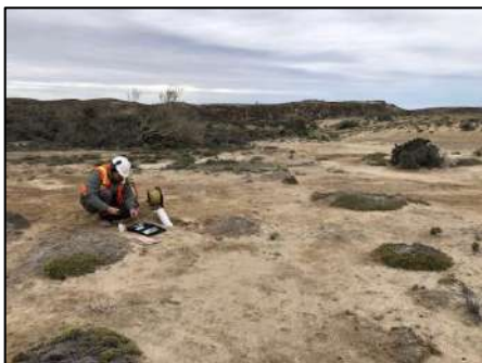
Fotografía 5.3. Muestreo de parámetros in situ en agua subterránea y medición de niveles.
